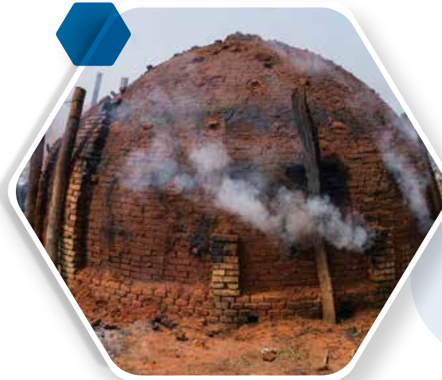
Slow Pyrolysis (kiln)
